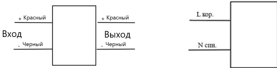
Схема подключения к сети постоянного тока ( 24, 48 В.)
